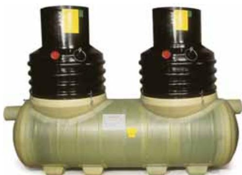
Жиросепараторы для подземной установки изготавливаются из армированного стеклопластика на намоточном станке с компьютерным управлением и по прочности намного превосходят ламинированные вручную отделители. Армированный стеклопластик не подвержен коррозии, и по химической стойкости намного прочнее бетона.
