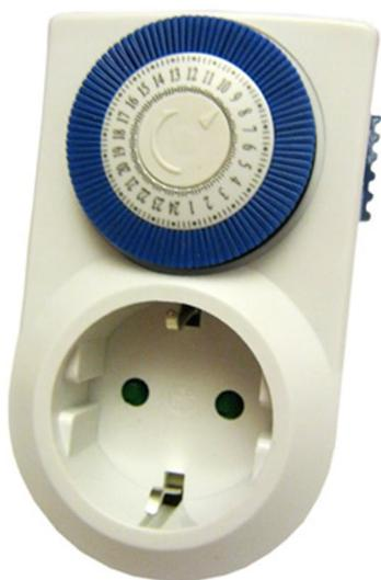
Настройка таймера. Таймер регулирует работу насоса подающего жидкость на распылитель и работает не постоянно, а 15 минут в час и 30 минут отдыхает. На таймере каждое деление соответствует 15 минутам, одно деление нажимаем, далее два пропускаем и так по кругу. Сбоку на корпусе переключатель устанавливаем в положение значка часов.
