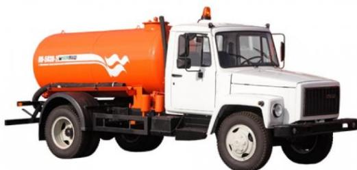
Очистка станции от нерастворимого осадка и жиров производится ассенизационным автомобилем не реже чем один раз в 12 месяцев из всех трех камер.
